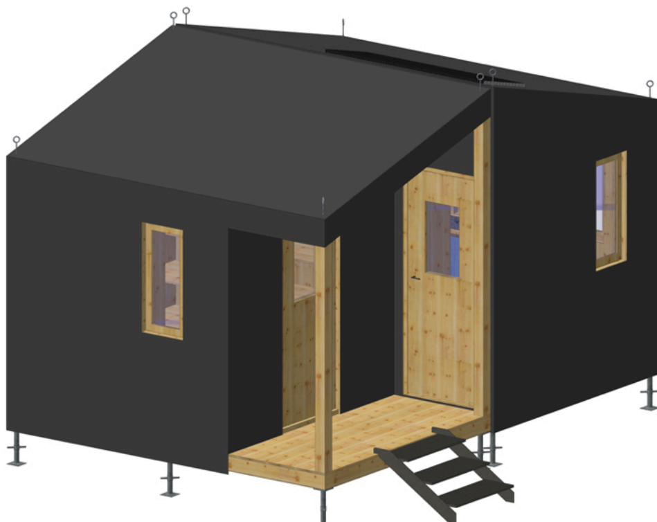
Combinaison du module d'habitation et du module de rangement
