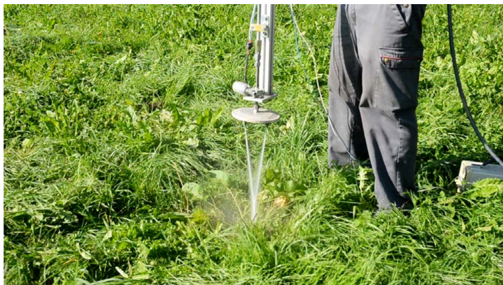
Essai de la tête d'application dans des conditions de terrain. Le chevauchement des jets d'eau au début de la procédure est clairement reconnaissable, Roy Latsch, Agroscope.
